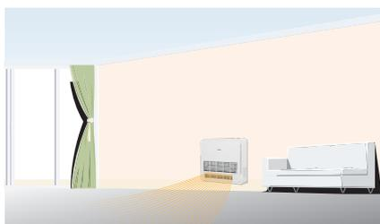
Nota: il deflettore dell'aria non può essere regolato manualmente. In modalità riscaldamento, se è selezionata la modalità di risparmio energetico, se la differenza di temperatura tra la temperatura impostata e la temperatura ambiente interna è inferiore a 1 °C, oppure l'UI entra in stato di spegnimento termico, il deflettore superiore viene chiuso automaticamente, e quindi permane solo il flusso d'aria inferiore.
