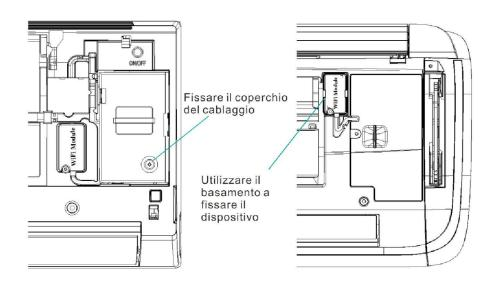
3, Utilizzare gli utensili a fissare il coperchio cablaggio e completare l'installazione del dispositivo WiFi. Non fissare il dispositivo WiFi con viti, ma con il basamento; poi legare i cavi. \* Il modo di installare deve corrispondere al specifico condizionatore, questa guida fornisce solo un riferimento.
