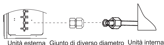
Collegare i tubi usando un giunto di diametro diverso
