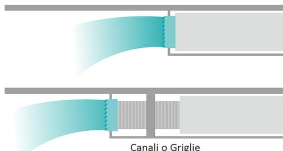
Grazie alla pressione statica utile, il flusso l'aria fluisce correttamente pur con la presenza di perdite di carico come canali griglie etc.
