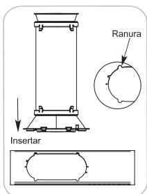
Alinee las solapas en el difusor con las ranuras en el panel de ventilación. Inserte el difusor en la abertura del panel de ventilación.
