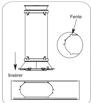
Aligner les languettes de l'adaptateur d'évacuation pour fenêtre avec les encoches du panneau d'évacuation.
