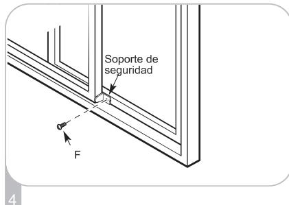
4 En caso de ser necesario, instale el bloqueo de la ventana con el tornillo F como se muestra.
