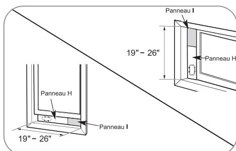
Pour des ouvertures de fenêtre de 19" à 26", utiliser le panneau d'évacuation pour fenêtre (Panneau H) et un panneau d'extension (Panneau I).
