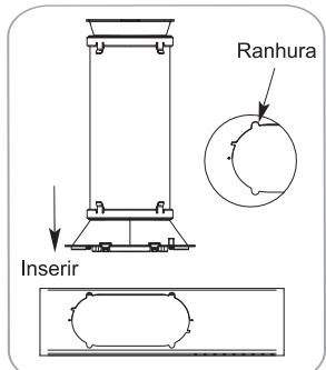
Alinhe as abas do adaptador do exaustor de janela com a abertura no painel de ventilação. Insira o adaptador do exaustor de janela na abertura do painel de ventilação.
