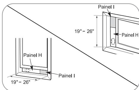
Para janelas com aberturas de 19" a 26", use o painel de ventilação (Painel H) e um painel de extensão (Painel I).
