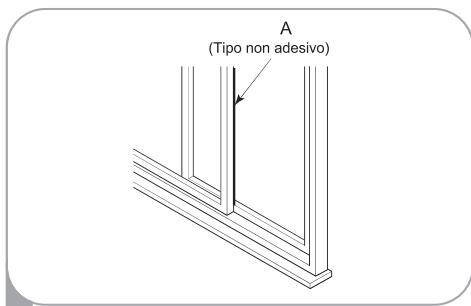
3 Tagliare la guarnizione in schiuma A (tipo non adesivo) alla larghezza della finestra. Infilare la guarnizione in schiuma A tra il vetro e la finestra per evitare che l'aria e i corpi estranei entrino nella stanza.
