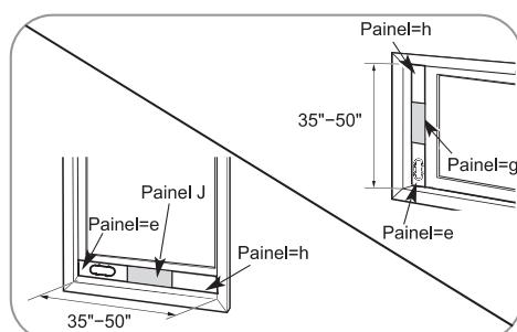
Para janelas com aberturas de 35" a 50", use o painel de ventilação e dois painéis de extensão (Painel K e Painel J).
