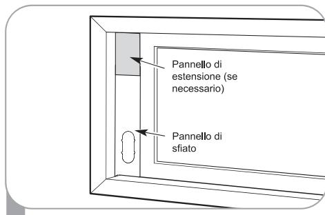
2 Inserire il gruppo del pannello di sfiato, compresi i pannelli di estensione, se necessario, nell'apertura della finestra. Estendere i pannelli di estensione, se utilizzati.
