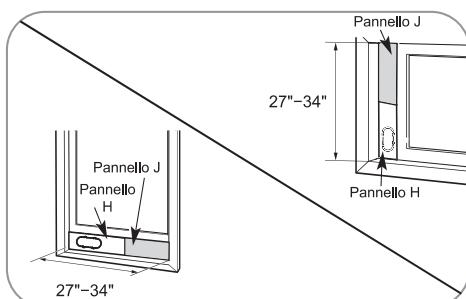
Per aperture di finestre da 27" a 34", utilizzare il pannello di sfiato della finestra (pannello H) e un pannello di estensione (pannello J).
