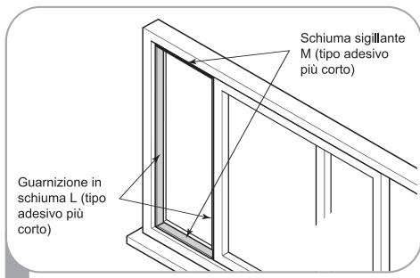
1 Tagliare la guarnizione in schiuma L (tipo adesivo) e M (tipo adesivo più corto) alla lunghezza adeguata e fissarla al battente e al telaio della finestra.
