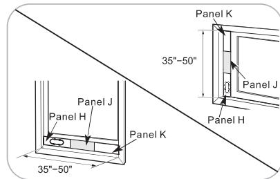
Para ventanas con aberturas desde 35" a 50", utilice un panel de ventilación y dos paneles de extensión (Panel K y Panel J).
