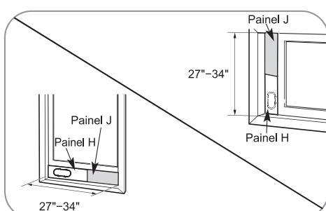
Para janelas com aberturas de 27" a 34", use o painel de ventilação (Painel H) e um painel de extensão (Painel J).
