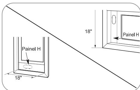
Para uma janela com abertura de 18", use apenas o painel de ventilação.
