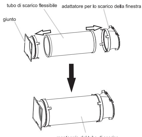
3. Inserire il giunto nella fessura sul retro del condizionatore d'aria.
