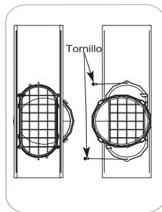
Inserte el tornillo en el orificio del difusor para evitar que el difusor se deslice fuera de la abertura de ventilación.
