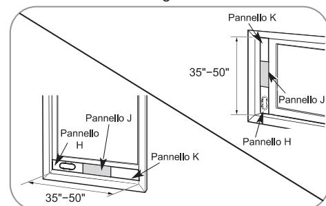
Per aperture di finestre da 35" a 50", utilizzare il pannello di sfiato della finestra e due pannelli di estensione (pannello K e pannello J).
