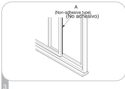
3 Corte la espuma aislante A (no adhesivo) en el ancho de la ventana. Rellene la espuma aislante A entre el vidrio y la ventana para evitar que el aire y los objetos externos ingresen a la habitación.
