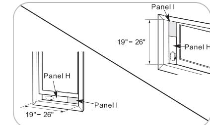
Para ventanas con aberturas desde 19" a 26", utilice un panel de ventilación (Panel H) y un panel de extensión (Panel I).
