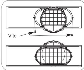
Inserire la vite nel foro dell'adattatore di scarico della finestra per evitare che l'adattatore di scarico della finestra scivoli fuori dall'apertura di sfiato
