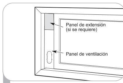
2 Inserte el montaje del panel de ventilación, incluyendo los paneles de extensión, si es necesario, en la abertura de la ventana. Extienda los paneles de extensión, si se utilizaron.
