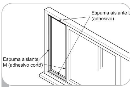
1 Corte la espuma aislante L (adhesivo) y M (adhesivo corto) a la longitud correcta y añádala al marco y guillotina de la ventana.
