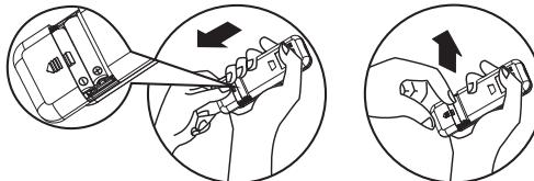
2. Insérer des piles neuves en s'assurant que les pôles (+) et (-) de la pile correspondent.
