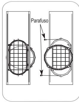
Prenda um parafuso no orifício do adaptador do exaustor de janela para evitar que o adaptador deslize e saia da abertura de ventilação.
