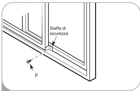
4 Installare la staffa di bloccaggio della finestra con una vite di tipo F come mostrato, se necessario.
