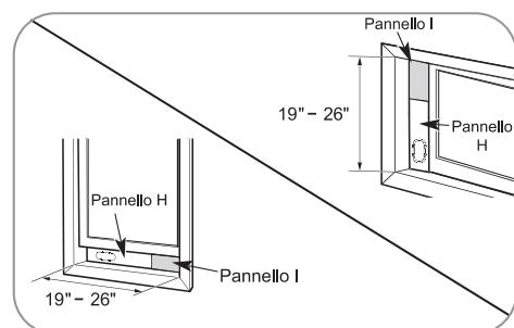
Per aperture di finestre da 19" a 26", utilizzare il pannello di sfiato della finestra (pannello H) e un pannello di estensione (pannello I).
