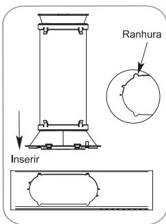
Alinhe as abas do adaptador do exaustor de janela com a abertura no painel de ventilação. Insira o adaptador do exaustor de janela na abertura do painel de ventilação.
