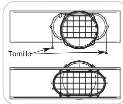
Inserte el tornillo en el orificio del difusor para evitar que el difusor se deslice fuera de la abertura de ventilación.
