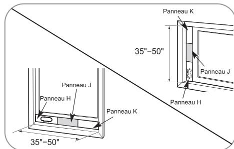
Pour des ouvertures de fenêtre de 35" à 50", utiliser le panneau d'évacuation pour fenêtre et deux panneaux d'extension (Panneau K et Panneau J).
