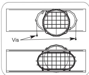
Insérez la vis dans le trou de l'adaptateur de vidange de la fenêtre pour éviter que l'adaptateur de drain de la fenêtre ne glisse hors de l'ouverture de ventilation
