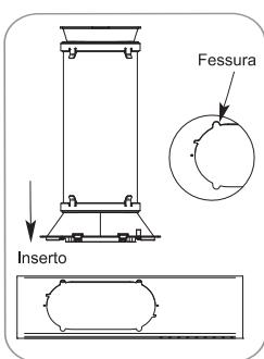
Allineare le linguette dell'adattatore di scarico della finestra con le fessure del pannello di sfiato.
