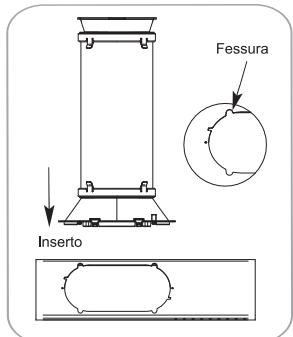
Allineare le linguette dell'adattatore di scarico della finestra con le fessure del pannello di sfiato. Inserire l'adattatore di scarico della finestra nell'apertura del pannello di sfiato.
