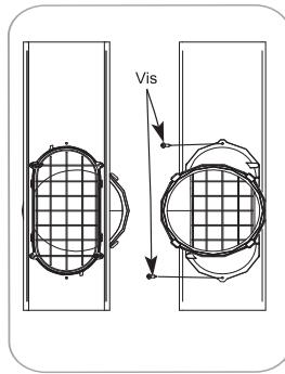
Insérez la vis dans le trou de l'adaptateur de vidange de la fenêtre pour éviter que l'adaptateur de drain de la fenêtre ne glisse hors de l'ouverture de ventilation.
