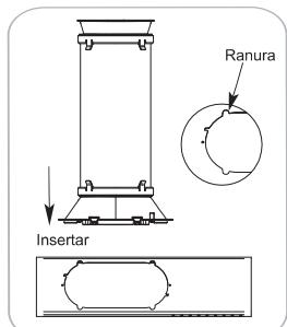
Alinee las solapas en el difusor con las ranuras en el panel de ventilación. Inserte el difusor en la abertura del panel de ventilación.
