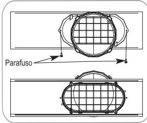
Prenda um parafuso no orifício do adaptador do exaustor de janela para evitar que o adaptador deslize e saia da abertura de ventilação
