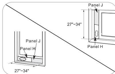
Para ventanas con aberturas desde 27" a 34", utilice un panel de ventilación (Panel H) y un panel de extensión (Panel J).
