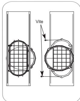
Inserire la vite nel foro dell'adattatore di scarico della finestra per evitare che l'adattatore di scarico della finestra scivoli fuori dall'apertura di sfiato.
