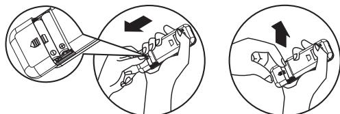
2. Inserire nuove batterie assicurandosi di posizionarle rispettando correttamente la polarità (+ e -).
