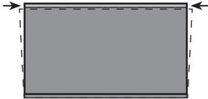
Se la parte superiore dell'immagine è più stretta dello schermo, utilizzare la chiave per ruotare i piedi sinistro e destro del televisore Laser in senso orario, finché i bordi sinistro e destro dell'immagine non siano paralleli ai bordi dello schermo.
