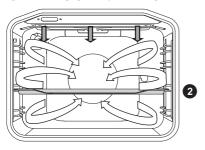
Con questo sistema funzionano simultaneamente il riscaldamento a raggi infrarossi e la ventola. È adatto per la cottura di carne, pesce, verdure.
