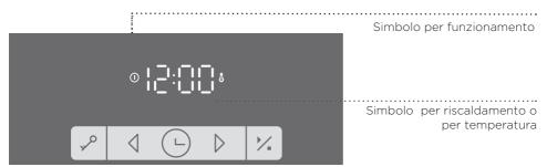
Durante il riscaldamento del forno il simbolo della temperatura lampeggia. Quando il forno raggiunge la temperatura impostata, il simbolo si illumina e si sente un breve segnale acustico.
