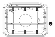
Il riscaldamento nella parte superiore e inferiore del forno trasmette uniformemente il calore all'interno del forno.
