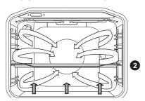
Si usa per la cottura di dolci a bassa lievitazione e per fare le conserve di frutta e verdura. Si usa il 2º livello da sotto e una forma da dolci non troppo alta in modo che l'aria riscaldata circoli anche sul lato superiore del cibo.
