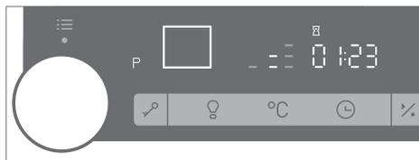
**3** La porta del forno, per la propria sicurezza, dopo un certo tempo si blocca automaticamente. Sul display viene visualizzato il simbolo di una chiavetta.
