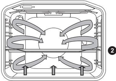
Funziona il riscaldamento inferiore e il riscaldamento circolare con ventola. Adatto per cuocere pizze, torte di mele, torte di frutta.
